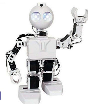
**ROBOTIQUE** • Apprends la robotique grâce à **JD**, un robot humanoïde équipé de 16 servomoteurs, d'une caméra et de 2 LEDs matricielles pour les yeux.
